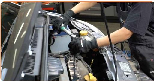
**25** Obdelajte konektor vžigalne tuljave s sprejem za elektroniko. Sprej bo zaščitil električne kontakte pred korozijo, oksidacijo in bo zmanjšal upor kontaktov.
