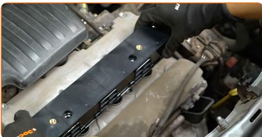
**24** Zategnite vijake vžigalne tuljave. Uporabite vijačni nastavek T30. Uporabite navorni ključ. Zategnite ga do navora 7 Nm.
