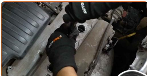
**22** Vstavite nove svečke in jih pričvrstite. Uporabite nastavek ključa za vžigalne svečke št. 16. Uporabite navorni ključ. Zategnite ga do navora 24 Nm.
