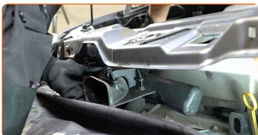
**5** Odvijte pritrdilni element pokrova motorja. Uporabite vijačni nastavek T30. Uporabite izvijač z zatikalom.
