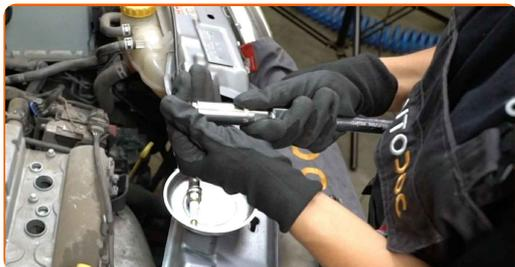
**20** Nanesite tanek sloj posebnega visokotemperaturnega maziva proti zatikanju na navoje novih vžigalnih svečk.
