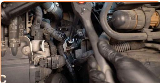
**22** Vnesite lijak. Vlijte novo tekočino menjalnika v menjalnik skozi odprtino odzračevalnika. Zahtevana količina olja: 1.6 l.
