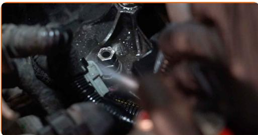
**21** Odvijte odzračevanje menjalnika. Uporabite nasadni ključ №16. Uporabite izvijač z zatikalom.
