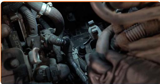
**20** Očistite odzračevanje menjalnika. Uporabite večnamenski čistilni sprej.
