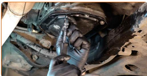
**19** Odstranite držala in umaknite cevovod hladilnega sredstva.
