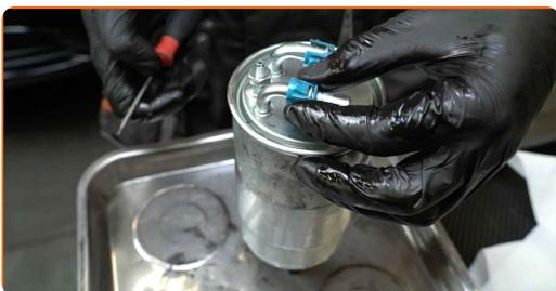
**10** Odstranite senzor za tlak goriva.
