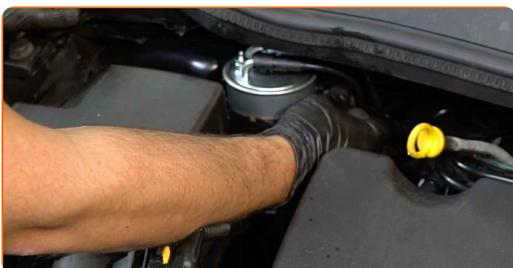
**16** Privijte namestitveni nosilec filtra za gorivo. Uporabite nasadni ključ №10. Uporabite izvijač z zatikalom.
