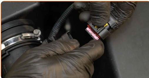
**4** Odstranite vpenjalni kos cevi za dovod zraka. Uporabite nasadni ključ №7. Uporabite izvijač z zatikalom.
