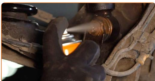
**28** Očistite nosilec platišča kolesa. Uporabite žično krtačo. Obdelajte kontaktno površino. Uporabite bakreno mast.
