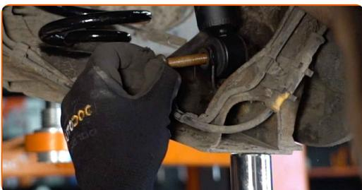
**22** Podprite zadnji nosilec vzmetenja. Uporabite dvigalko s hidravličnim prenosom.
