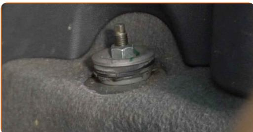
**4** Očistite pritrdilne elemente zgornjega nosilca amortizerja. Uporabite sprej WD-40.
