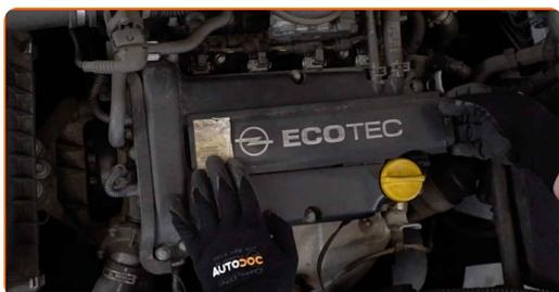
**3** Odklopite konektor z vžigalne tuljave. Uporabite ploščat izvijač.
