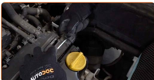
**4** Odvijte nosilec vžigalne tuljave. Uporabite vijadni nastavek T30. Uporabite izvijač z zatikalom.
