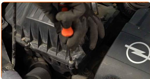
**14** Priključite dovodno cev zraka na ohišje zračnega filtra.
