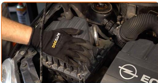
**13** Privijte pritrdilne vijake pokrova zračnega filtra. Uporabite Phillips križni izvijač.
