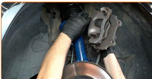
Menjava: kolesnega ležaja – VAUXHALL Corsa Mk III (D) Hatchback (S07).
