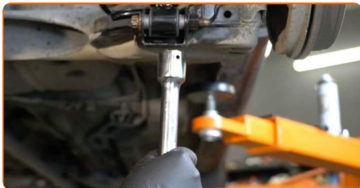
**Menjava: vzmeti – VAUXHALL Corsa Mk III (D) Hatchback (S07). Nasvet:**
