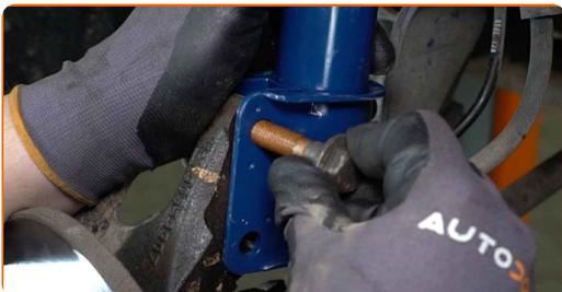
**42** Zategnite spodnje pritrdilne elemente vzmetne noge. Uporabite kombinirani ključ №18. Uporabite nasadni ključ №18. Uporabite izvijač z zatikalom.
