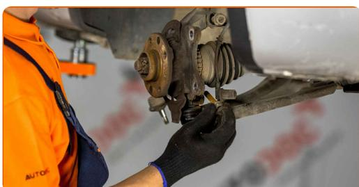
**23** Odstranite razcepko pritrdilnega pesta matice. Uporabite rezalne klešče.
