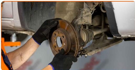
**12** Odstranite ABS senzor s krmilnega členka. Uporabite imbus št. H5. Uporabite izvijač z zatikalom.
