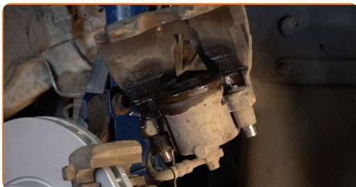
Menjava: zavornih ploščic – VAUXHALL COMBO Mk II (C) zaboj /kombi (F25).
