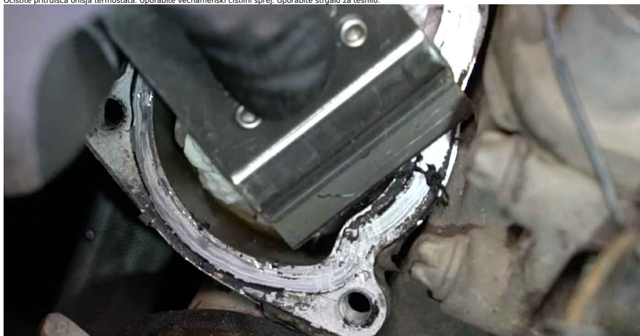
25 Namestite novo ohišje termostata skupaj s termostatom.
