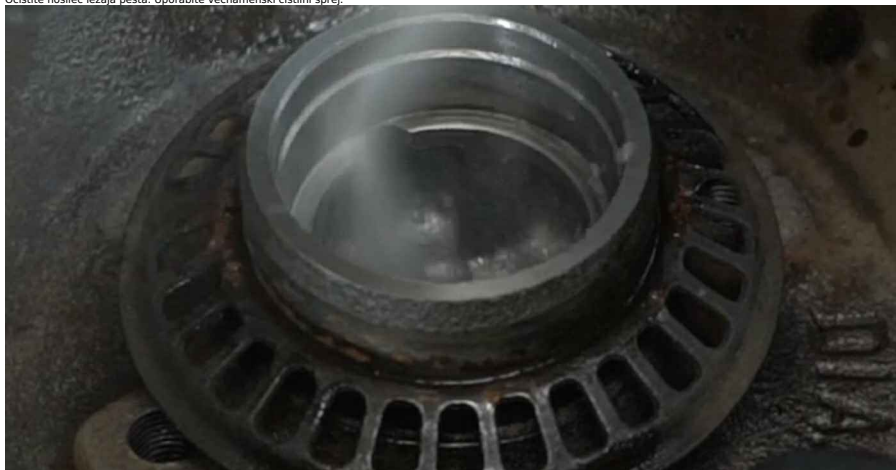
18 Namestite novi zunanji obroč kolesnega ležaja v zavorni boben. Komplet puše in ležaja gonila.
