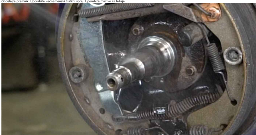
24 Namestite zavorni boben, sestavljen z ležajem pesta kolesa.
