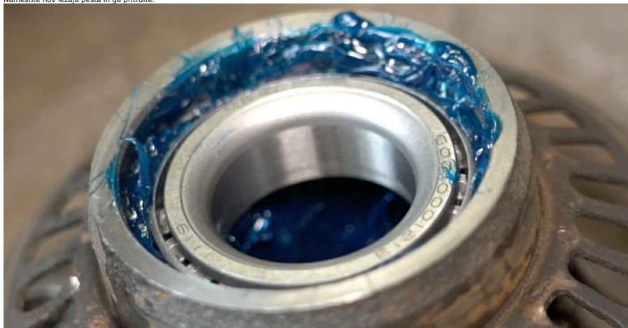
22 Namestite oljno tesnilo kolesnega ležaja.
