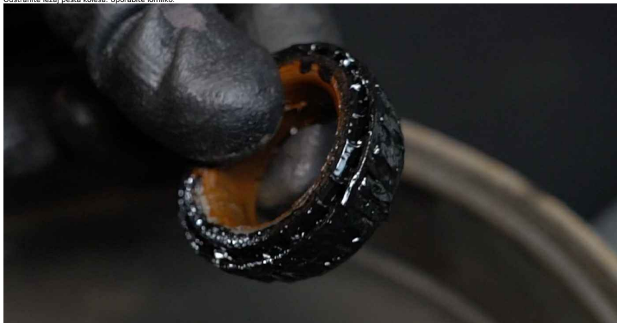
14 Očistite nosilec ležaja pesta.
