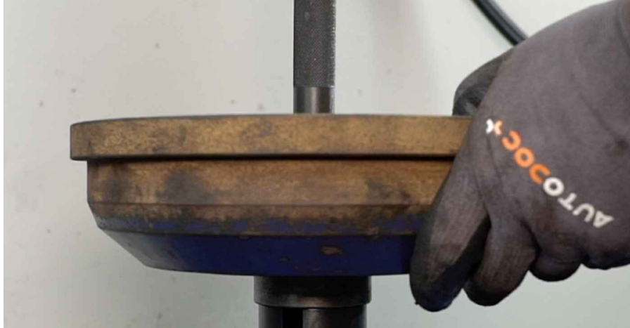
17 Očistite nosilec ležaja pesta. Uporabite večnamenski čistilni sprej.
