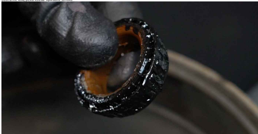
14 Očistite nosilec ležaja pesta.
