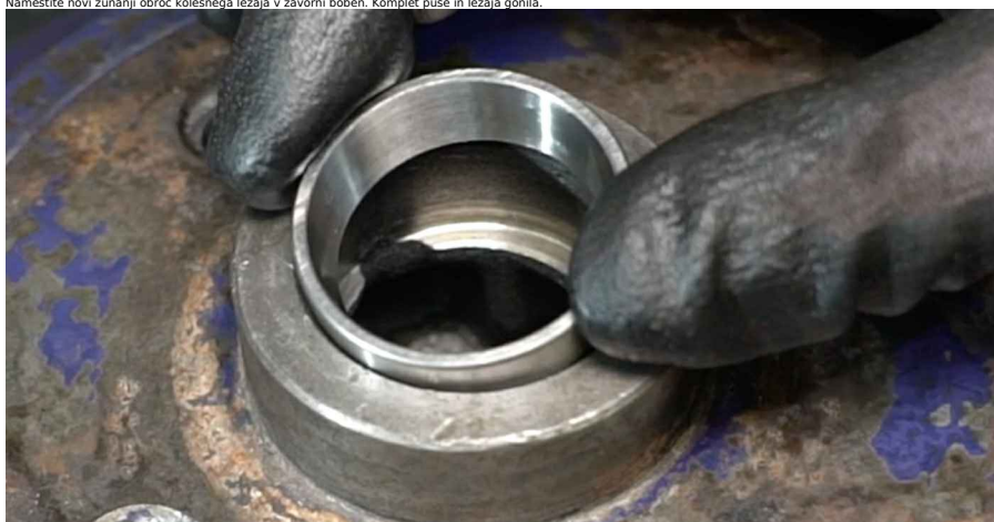
19 Namestite nov notranji obroč ležaja kolesa v zavorni boben. Komplet puše in ležaja gonila.
