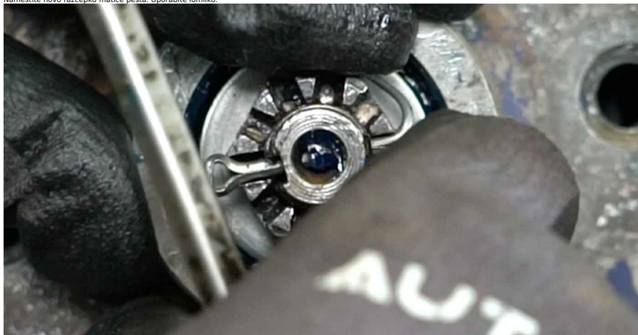
34 Namestite pokrovčke matice peste. Uporabite gumijasto kladivo.
