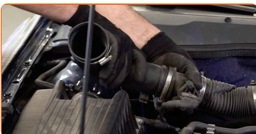
**6** Pokrijte cev za dovod zraka s krpo iz mikrovlaken, da preprečite vnos prahu in umazanije v sistem.
