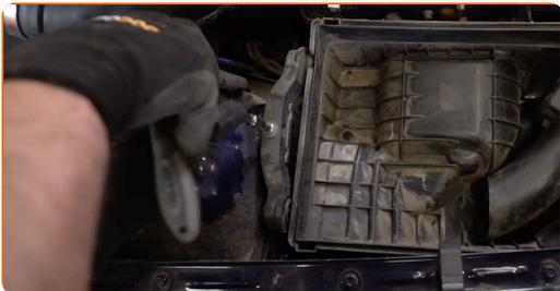
**10** Odstranite ohišje zračnega filtra.
