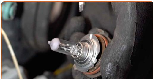
**13** Preverite stanje terminalov nosilca žarnice. Po potrebi ga zamenjajte.
