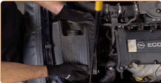
**9** Odvijte pritrdilne vijake ohišja filtra. Uporabite vijačni nastavek T30. Uporabite izvijač z zatikalom.
