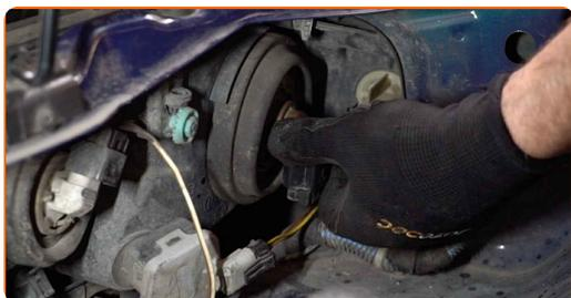
**12** Odstranite staro žarnico. Uporabite ploščat izvijač.
