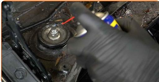
10 Sprostite zgornji pritrdilni element sedeža za namestitev blažilnika. Uporabite nasadni ključ za blažilnik №9. Uporabite nasadni ključ №18. Uporabite izvijač z zatikalom.
