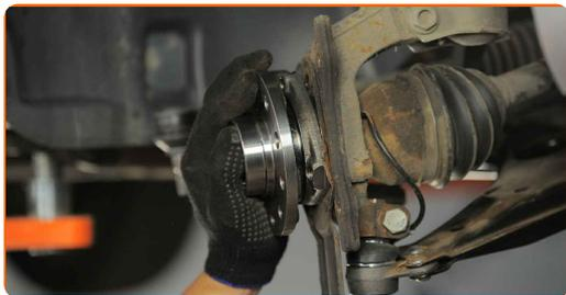
**27** Zategnite vijake pesta. Uporabite nasadni ključ N°E18. Uporabite navorni ključ. Zategnite ga do navora 90 Nm.+45°
