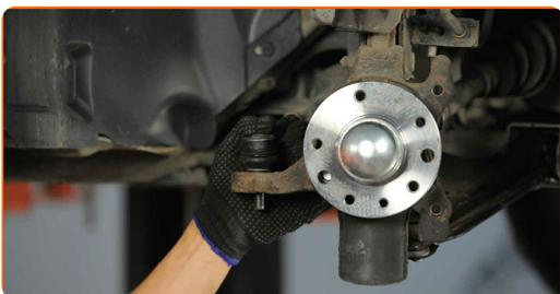
**32** Zategnite pritrdilno matico, ki pvoezuje glavo jarmovega droga s premnikom. Uporabite nasadni ključ №19. Uporabite navorni ključ. Zategnite ga do navora 30 Nm.+90°
