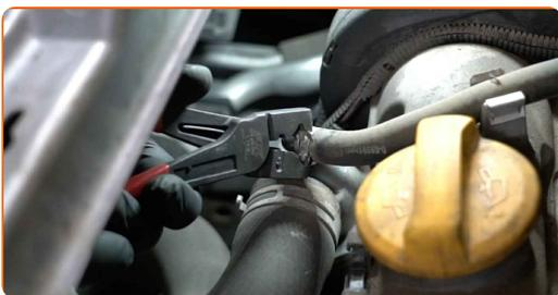
**22** Odstranite cev hladilne tekočine. Uporabite ploščat izvijač.
