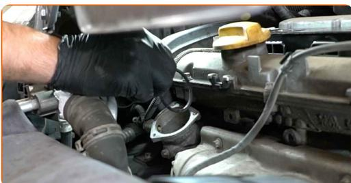
**29** Pritrdišče ohišja termostata pokrijte s krpo iz mikrovlagen, da preprečite vdor umazanije in tujkov v sistem.
