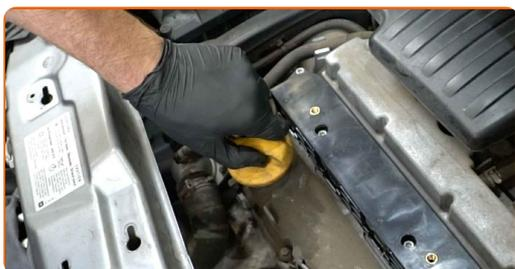
**49** Pokrijte odprtino lijaka za nalivanje olja s krpo iz mikrovlagen, da preprečite vdor umazanije in tujkov v sistem.
