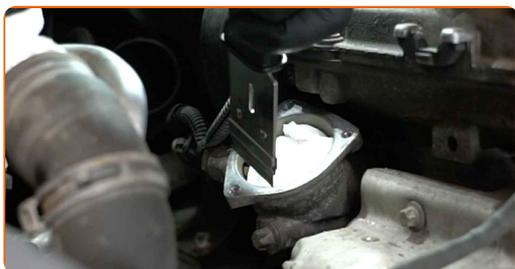
**31** Odstranite krpo iz mikrovlagen s pritrdišča ohišja termostata.
