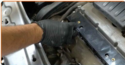
**50** Namestite pokrov motorja in ga pričvrstite.
