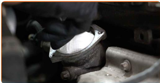
**30** Očistite pritrdišča ohišja termostata. Uporabite strgalo za tesnilo. Uporabite večnamenski čistilni sprej.
