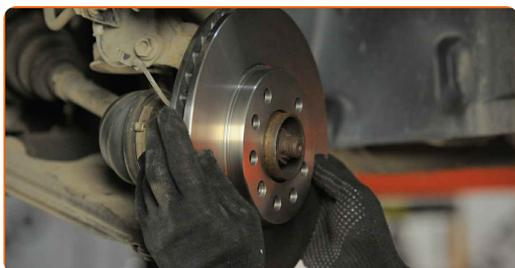
**23** Zategnite pritrditve zavornega diska. Uporabite imbus št. H5. Uporabite navorni ključ. Zategnite ga do navora 7 Nm.
