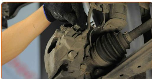
**33** Namestite blokirno vzmet zavorne čeljusti. Uporabite ploščat izvijač. Uporabite kleščice.
