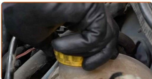
38 Pustite da motor nekaj minut deluje. To je potrebno storiti zato, da odstranite odvečen zrak iz hladilnega sistema in da preverite, ali komponente delujejo pravilno.
