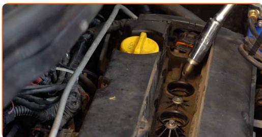
**10** Nanesite tanek sloj posebnega visokotemperaturnega maziva proti zatikanju na navoje novih vžigalnih svečk.
