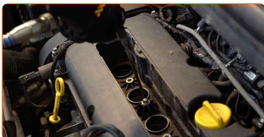
**8** Odvijte vžigalne svečke. Uporabite nastavek ključa za vžigalne svečke št. 16. Uporabite izvijač z zatikalom.
