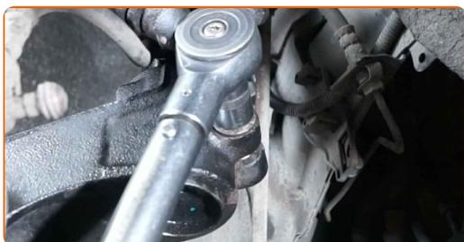
**81** Zategnite pritrdilne elemente nosilca zavornega sedla. Uporabite nasadni ključ №18. Uporabite navorni ključ. Zategnite ga do navora 150 Nm.
