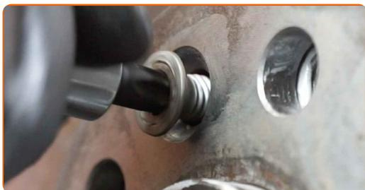
**75** Zategnite pritrdilne elemente zavornega koluta. Uporabite vijačni nastavek T50. Uporabite navorni ključ. Zategnite ga do navora 15 Nm.
