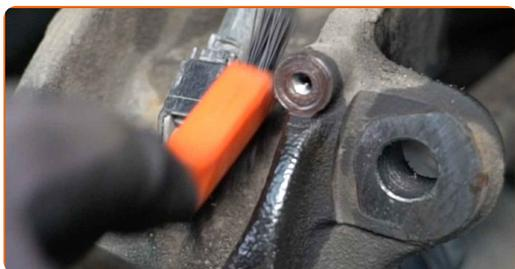
**26** Odklopite konektor ABS senzorja.
