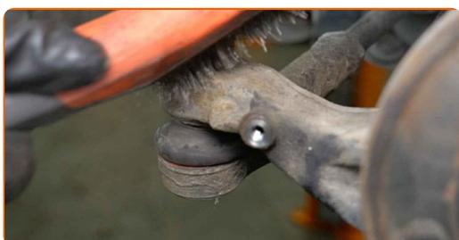
**31** Odvijte pritrdilno matico, ki povezuje konec jarmskega droga s premnikom. Uporabite nasadni ključ №22. Uporabite izvijač z zatikalom.
