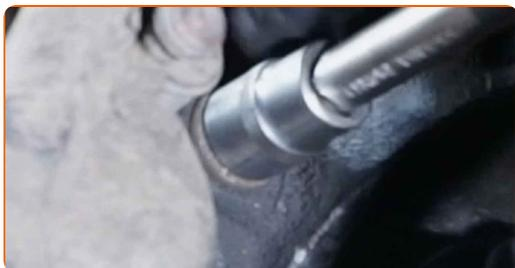
**82** Zategnite pritrdilni element, ki povezuje kroglični sklep s premnikom. Uporabite kombinirani ključ №21. Uporabite navorni ključ. Zategnite ga do navora 110 Nm.
