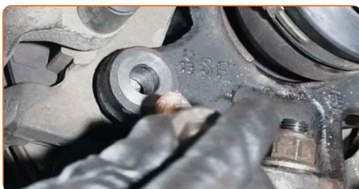
**78** Zategnite pritrdilne elemente nosilca zavornega sedla. Uporabite nasadni ključ №18. Uporabite izvijač z zatikalom.
