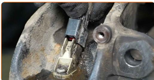
**27** Odklopite napeljavo ABS-senzorja.
