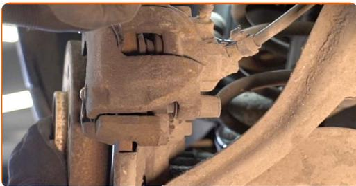
**8** Odstranite pokrovčke manšete vodilnih zatičev zavornih čeljusti. Uporabite lomilko.
