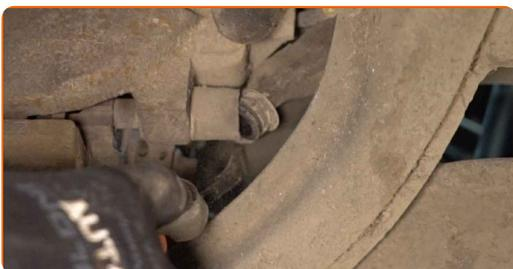
**9** Odvijte pritrditve zavorne čeljusti. Uporabite imbus št. H7. Uporabite izvijač z zatikalom.
