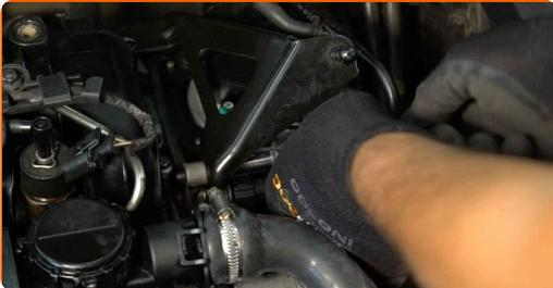
**5** Odstranite priključek senzorja za tlak goriva. Uporabite ploščat izvijač.
