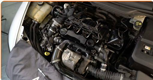
**4** Odvijte vijke nosilca filtra za zrak. Uporabite nasadni ključ №8. Uporabite nasadni ključ №10. Uporabite izvijač z zatikalom.
