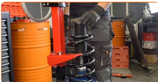
**50** Namestite zgornji nosilec opornika in ležaj nosilca opornika.
