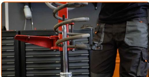
45 Odstranite stari amortizer s kompresorja hidravlične spiralne vzmeti.
