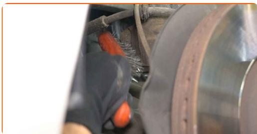
**31** Odvijte pritrdilne elemente, ki povezujejo vzmetno nogo s premnikom. Uporabite nasadni ključ №18. Uporabite izvijač z zatikalom.
