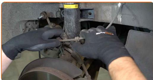
**23** Odvijte pritrdilni element pogonske gredi na pesto kolesa. Uporabite nasadni ključ №30. Uporabite izvijač z zatikalom.
