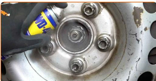
**15** Sprostite pritrdilni element pogonske gredi. Uporabite nasadni ključ №30. Uporabite udarni nasadni ključ.
