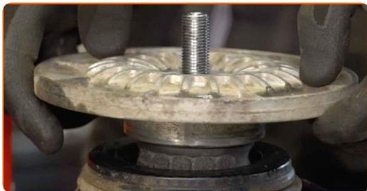
49 Zategnite matico amortizerja. Uporabite nasadni ključ №21. Uporabite imbus št. H7. Uporabite navorni ključ. Zategnite ga do navora 80 Nm.
