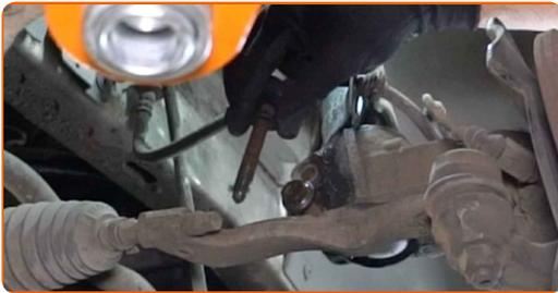
33 Sprostite spodnji pritrdilni element, ki povezuje blažilnik s premnikom. uporabite poseben nastavek za nasadni ključ za odstranitev blažilnika. Uporabite izvijač z zatikalom.
