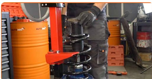
48 Namestite zgornji nosilec opornika in ležaj nosilca opornika.
