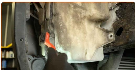
**13** Odklopite konektor s črpalke tekočine za pranje vetrobranskega stekla. Uporabite montažni vzvod.
