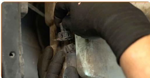
**14** Pod črpalko tekočine za pranje vetrobranskega stekla postavite posodo.
