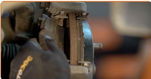
**12** Očistite nosilce zavornih čeljusti. Uporabite žično krtačo. Uporabite sprej WD-40.
