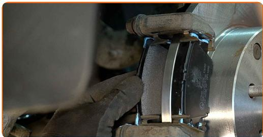
**26** Namestite zavorno čeljust in jo privijte. Uporabite nasadni ključ №14. Uporabite navorni ključ. Zategnite ga do navora 27 Nm.
