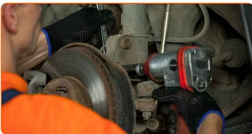
**49** Obdelajte pritrdilne elemente blažilnika. Uporabite bakreno mast.
