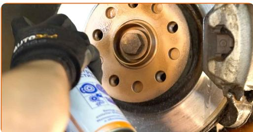
**51** Očistite površino zavornih kolutov. Uporabite čistilo zavor.
