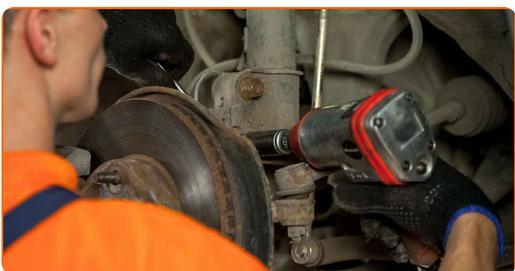
**45** Pritrdite zavorno cev na opornik. Povežite pritrditev kabla ABS senzorja z opornikom amortizerja. Uporabite nasadni ključ №12. Uporabite izvijač z zatikalom.
