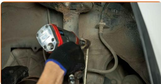
**48** Pritrdite spodnje pritrdilne elemente, ki povezujejo blažilnik in premnik. Uporabite kombinirani ključ №19. Uporabite nasadni ključ №19. Uporabite navorni ključ. Zategnite ga do navora 143 Nm.
