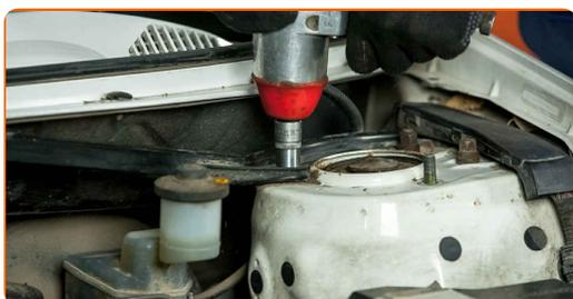
**19** Odvijte pritrdilne elemente na vrhu nosilca amortizerja.
