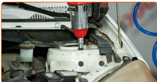
**37** Obdelajte pritrdilne elemente sedeža za namestitev blažilnika. Uporabite bakreno mast.
