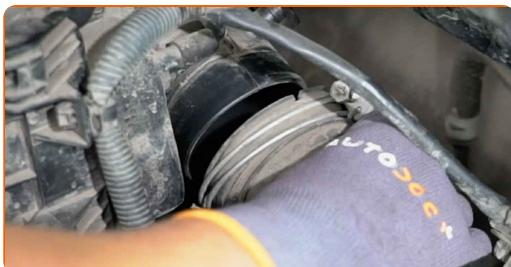
8 Pokrijte cev za dovod zraka s krpo iz mikrovlaken, da preprečite vnos prahu in umazanije v sistem.
