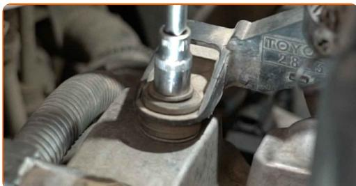
7 Odklopite dovodno cev zraka z ohišja zračnega fitra.
