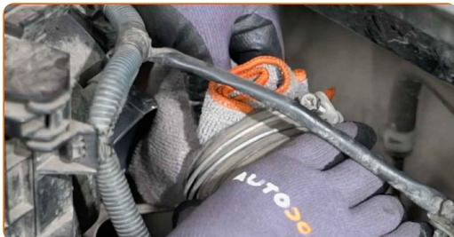
9 Postavite ohišje zračnega filtra na stran.
