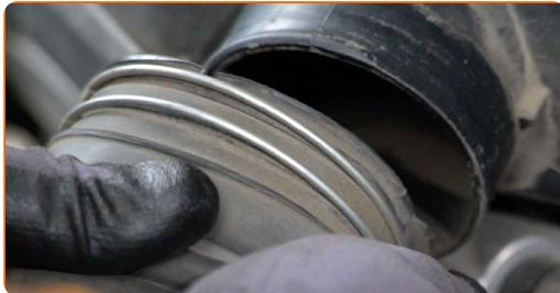
5 Odvijte pritrdilne elemente ohišja zračnega filtra. Uporabite nasadni ključ №10. Uporabite izvijač z zatikalom.
