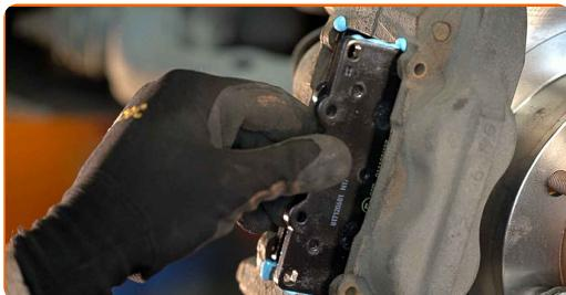
Menjava: zavornih ploščic – TOYOTA HILUX pick-up (GUN1\_). AUTODOC priporoča:
