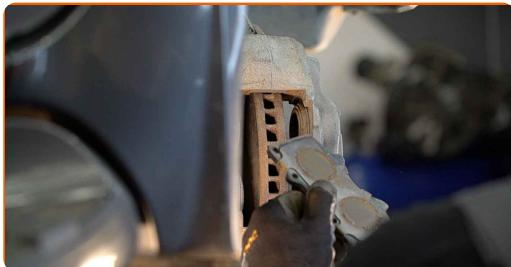
Menjava: zavornih ploščic – TOYOTA HILUX pick-up (GUN1\_). AUTODOC
