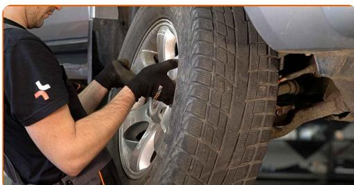
Menjava: zavornih ploščic – TOYOTA HILUX pick-up (GUN1\_). Nasvet AUTODOC strokovnjakov:
