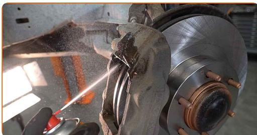
Menjava: zavornih ploščic – TOYOTA HILUX pick-up (GUN1\_). Nasvet:
