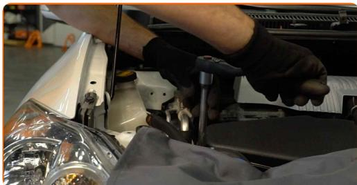
**14** Odvijte zgornji pritrdilni element nosilca motorja. Uporabite nasadni ključ №17. Uporabite izvijač z zatikalom.
