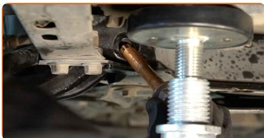
**27** Očistite vse sklepe prečnega vodila. Uporabite žično krtačo. Uporabite sprej WD-40.
