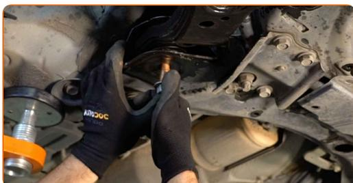
**30** Privijte zadnji pritrdilni element, ki povezuje upravljalni vzvod in pomožni okvir. Uporabite kombinirani ključ №22. Uporabite nasadni ključ №22. Uporabite izvijač z zatikalom.
