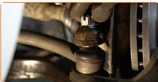
**18** Zategnite pritrdilno matico, ki povezuje glavo jarmovega droga s premnikom. Uporabite nasadni ključ №19. Uporabite navorni ključ. Zategnite ga do navora 49 Nm.
