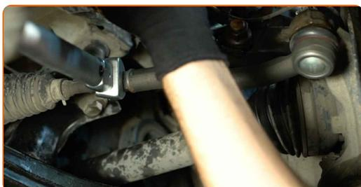
**21** Obdelajte pritrdilni element, ki povezuje glavo jarmovega droga s premnikom. Uporabite bakreno mast.
