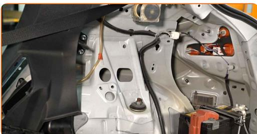
**13** Očistite pritrdilne elemente zgornjega nosilca amortizerja. Uporabite žično krtačo. Uporabite sprej WD-40.
