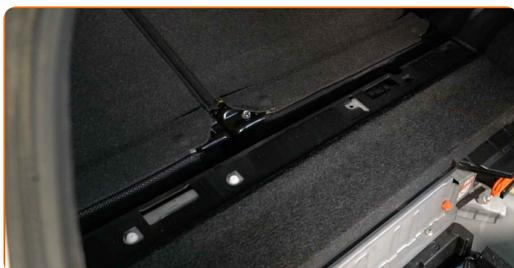
**8** Odvijte pritrdilni element iz osrednje zaščitne plastične plošče. Uporabite nasadni ključ №10. Uporabite izvijač z zatikalom.
