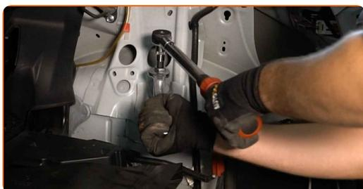
**40** Obdelajte pritrdilne elemente amortizerja. Uporabite bakreno mast.
