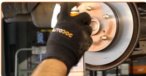
**35** Očistite površino zavornih kolutov. Uporabite čistilo zavor.
