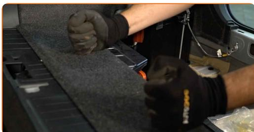
**44** Privijte pritrdilni element osrednje zaščitne plastične plošče. Uporabite nasadni ključ №10. Uporabite izvijač z zatikalom.
