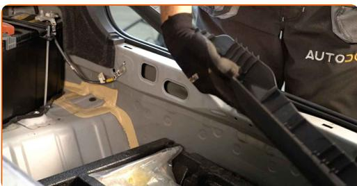
**12** Odvijte pritrdilni element in odstranite stransko zvočno izolacijo prtlažnika.
