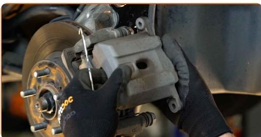
Menjava: zavornih ploščic – TOYOTA COROLLA stopnicasti zadek (\_E12J\_, \_E12T\_). Nasvet:
