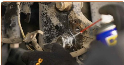
**13** Odvijte pritrdilni element, ki povezuje jarmov drog na blažilnik. Uporabite kombinirani ključ №17. Uporabite imbus št. H6. Uporabite izvijač z zatikalom.
