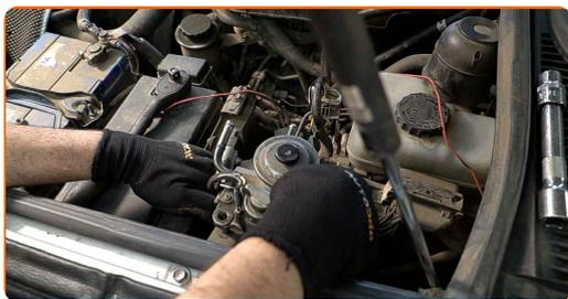
**28** Zategnite pritrdilne elemente filtra za gorivo. Uporabite nasadni ključ №12. Uporabite izvijač z zatikalom.
