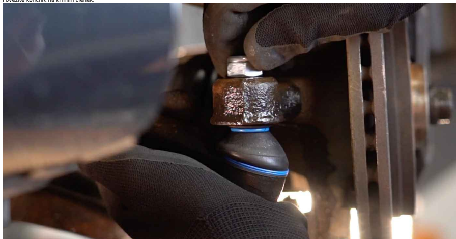
18 Zategnite pritrilno matico, ki povezuje glavo jarmovega droga s premnikom. Uporabite nasadni ključ №17. Uporabite navorni ključ. Zategnite ga do navora 33 Nm.
