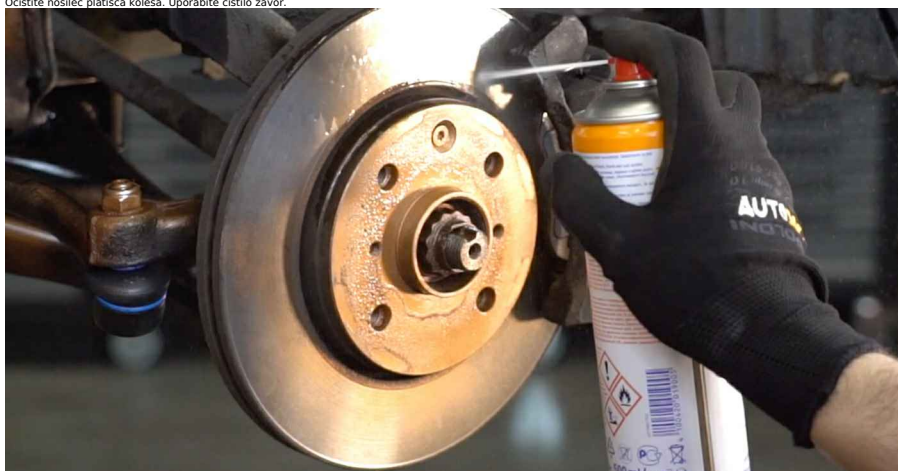
23 Očistite nosilec platišča kolesa. Uporabite čistilo zavor.
