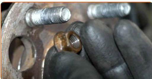
**27** Odvijte pritrdilni element pogonske gredi na pesto kolesa. Uporabite nasadni ključ №30. Uporabite izvijač z zatikalom.
