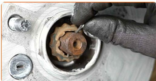
**59** Obdelajte pritrdilni element pogonske gredi. Uporabite bakreno mast.
