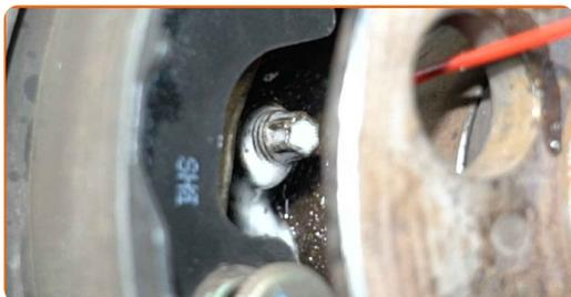
**25** Odvijte pritrdilne elemente ležaja pesta kolesa. Uporabite nasadni ključ №14. Uporabite izvijač z zatikalom.
