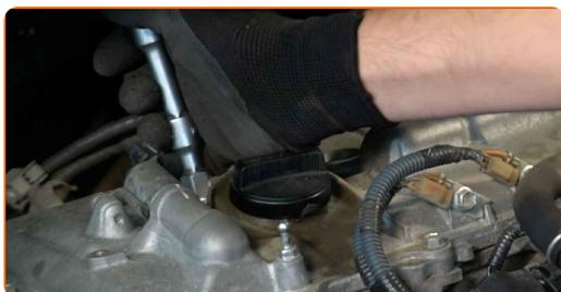
**13** Vstavite nove svečke in jih pričvrstite. Uporabite nastavek ključa za vžigalne svečke št. 16. Uporabite navorni ključ. Zategnite ga do navora 20 Nm.
