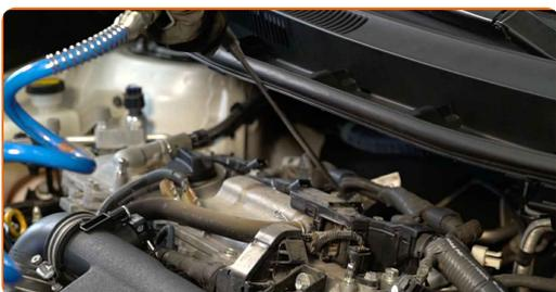
**6** Odvijte pritrdilne elemente vžigalne tuljave. Uporabite nasadni ključ №10. Uporabite izvijač z zatikalom.
