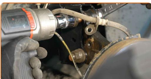
**45** Pritrdite spodnje pritrdilne elemente, ki povezujejo blažilnik in premnik. Uporabite nasadni ključ №22. Uporabite navorni ključ. Zategnite ga do navora 240 Nm.
