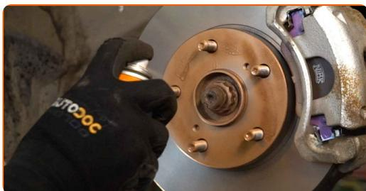
**52** Očistite površino zavornih kolutov. Uporabite čistilo zavor.
