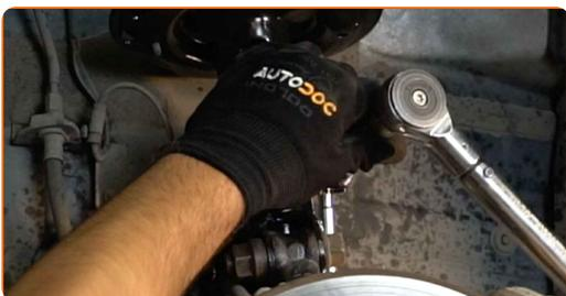
**50** Obdelajte pritrdilne elemente blažilnika. Uporabite bakreno mast.
