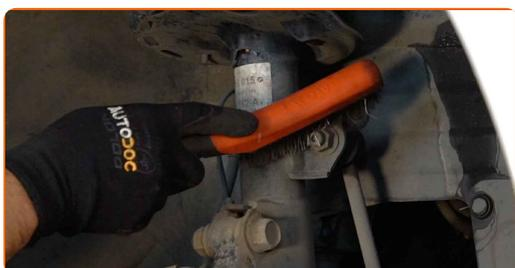
**11** Odklopite kable in zavorno cev iz nosilca za amortizer. Uporabite nasadni ključ №14. Uporabite izvijač z zatikalom.
