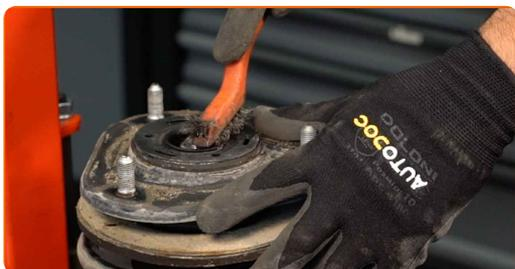
**25** Odstranite matico oporne batnice. Uporabite verižni ključ. Uporabite nasadni ključ №21. Uporabite izvijač z zatikalom.
