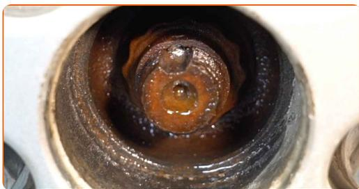
**3** Sprostite pritrdilni element pogonske gredi. Uporabite nasadni ključ №30. Uporabite udarni nasadni ključ.
