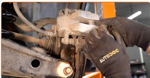
**32** Zategnite nosilec zavorne čeljusti. Uporabite nasadni ključ №18. Uporabite navorni ključ. Zategnite ga do navora 88 Nm.
