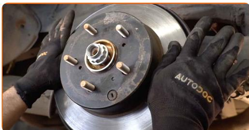
**30** Očistite mesto namestitve čeljusti in njene nosilce. Uporabite žično krtačo. Uporabite sprej WD-40.
