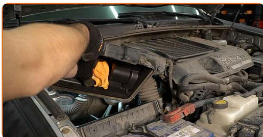
**7** Očistite pokrov zračnega filtra in ohišje.
