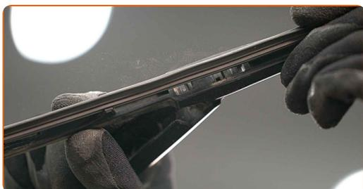
4 Odstranite metlico iz ročice brisalnika.
