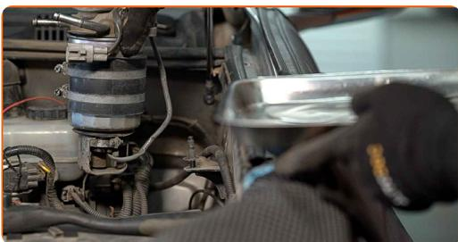
**8** Odvijte nosilec senzorja za vodo v gorivu. Uporabite nasadni ključ №8.
