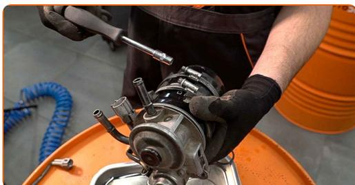
**21** Odstranite O-obroč senzorja vode v gorivu. Uporabite ploščat izvijač.
