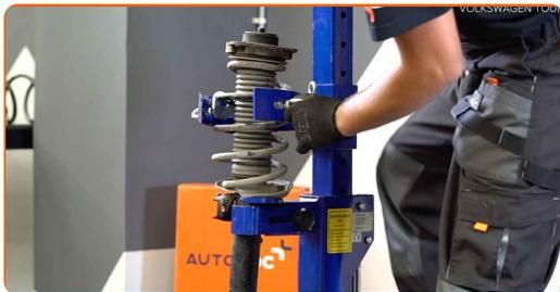
**34** Odvijte pritrdilne elemente na vrhu nosilca amortizerja. Uporabite kombinirani ključ N°18. Uporabite imbus št. H6.
