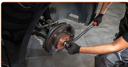
57 Očistite nosilec platišča kolesa. Uporabite žično krtačo. Obdelajte kontaktno površino. Uporabite bakreno mast.
