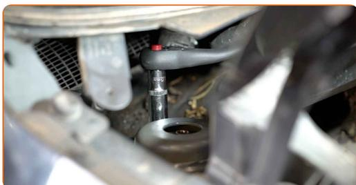
49 Popravite opornik amortizerja na členku volana.
