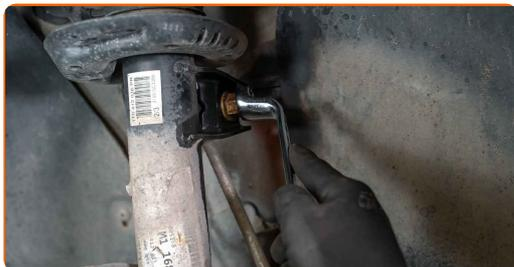
23 Odstranite senzor kontrolnega sistema nivoja s kontrolne ročice vzmetenja.
