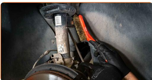
22 Odvijte matico in odstranite drog stabilizatorja z opornika. Uporabite kombinirani ključ N°18. Uporabite XZN št. 6.
