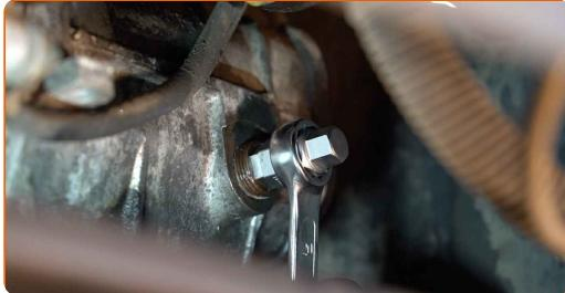
**11** Privijte nov drenažni čep in ga zategnite. Uporabite imbus št. H17. Uporabite navorni ključ. Zategnite ga do navora 29 Nm.
