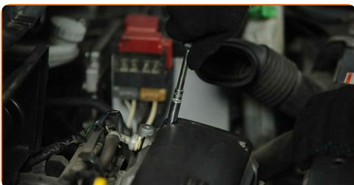
**25** Ponovno namestite ohišje zračnega filtra.
