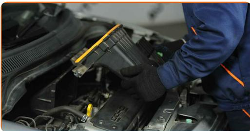
**26** Priključite dovodno cev zraka na ohišje zračnega filtra.
