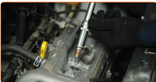
**18** Vstavite nove svečke in jih pričvrstite. Uporabite nastavek ključa za vžigalne svečke št. 16. Uporabite navorni ključ. Zategnite ga do navora 25 Nm.
