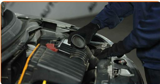
**6** Odstranite ohišje zračnega filtra.
