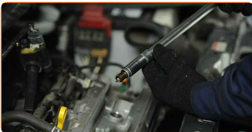
**16** Nanesite tanek sloj posebnega visokotemperaturnega maziva proti zatikanju na navoje novih vžigalnih svečk.
