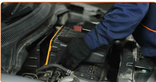
**7** Odvijte pritrdilni element pokrova motorja. Uporabite nasadni ključ N°8. Uporabite izvijač z zatikalom.
